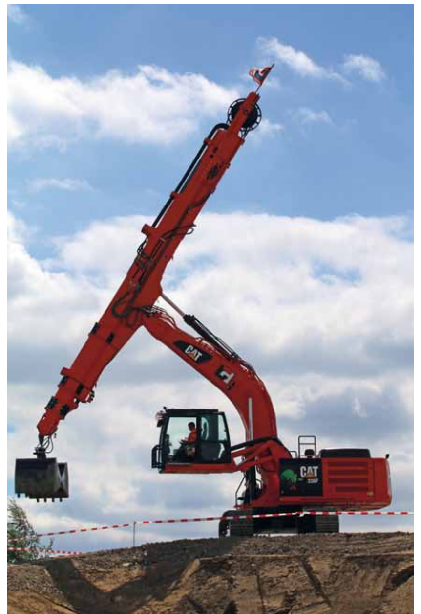
Der Teleskop wird hydraulisch mit Zylindern angetrieben und kann so einen punktuellen Druck auf das Erdreich ausüben.
