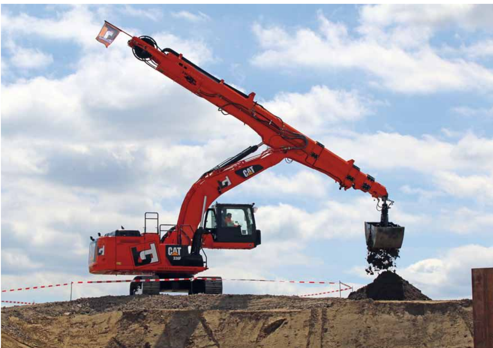
Der Ausleger samt Teleskopstiel wurde für den Einsatz mit einem 1,5 Kubikmeter großen Zweischalengreifer konstruiert.
